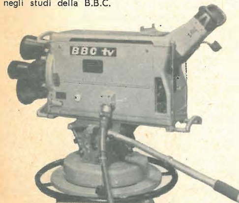
Una delle tante telecamere « Marconi Mark IV » usate negli studi della B.B.C.
