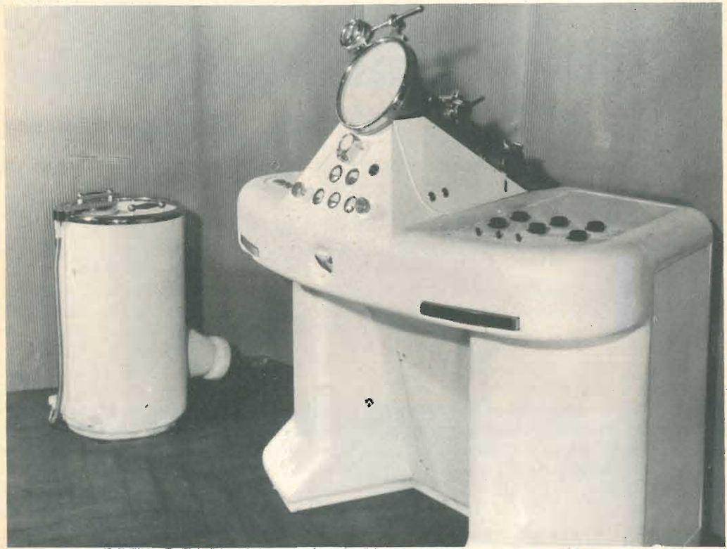
Il microscopio elettronico FM 100 C possiede un potere separatore superiore a 20 Angstrom. Le cinque lenti elettromagnetiche di cui è munito consentono di ottenere ingrandimenti fino a 90.000 volte.
