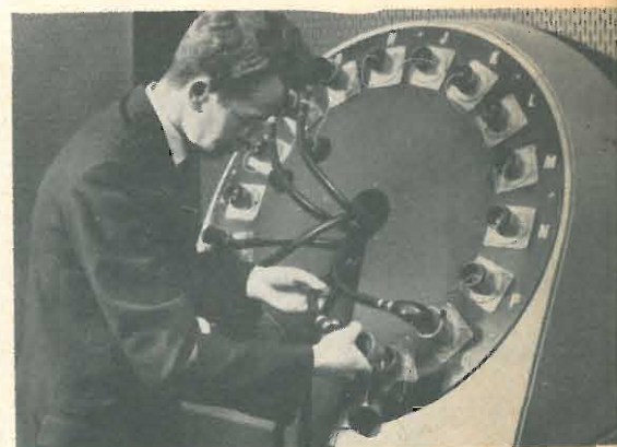
Pannello per il collegamento delle varie telecamere all'unità di controllo e al « mixer ».
